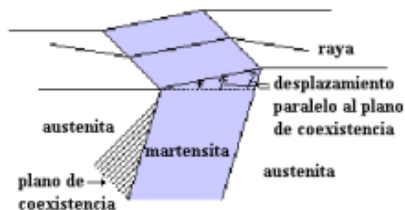
Fig. 2. Aspecto macroscópico esquemático de una plaqueta de martensita en un monocristal de fase austenítica.
