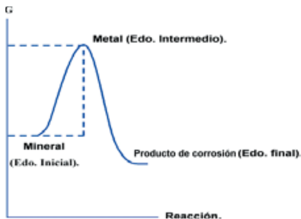
Fig. 1. Gráfica muestra el estado del (mineral-metal-producto de corrosión) en función de la energía de Gibbs.
