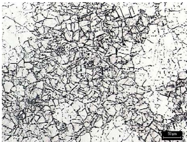
Fig. 8. Microestructura de muestra sin maquinar con tamaño de grano ASTM 4.
