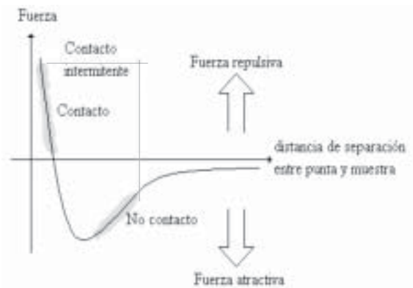
Fig. 2. Gráfico de fuerza vs. distancia, entre la muestra y la punta del MFA.
