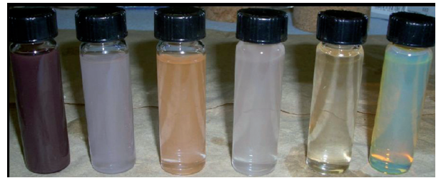
Fig. 3. Fotografías que muestran el cambio de color en las dispersiones coloidales de las nanopartículas de AuAg con el incremento del número de capas.
