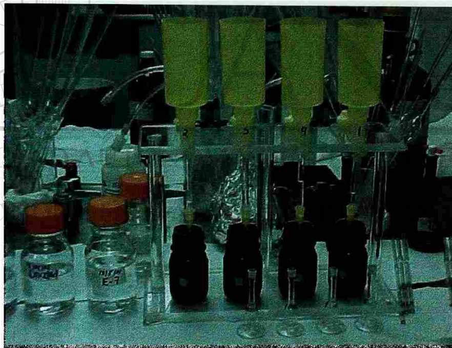
Figura 24. Fotografías de los sistemas SPE SAX y de afinidad. Sistema de extracción en fase sólida (SPE) SAX (superior). Sistema de purificación por cromatografía de afinidad (inferior).
