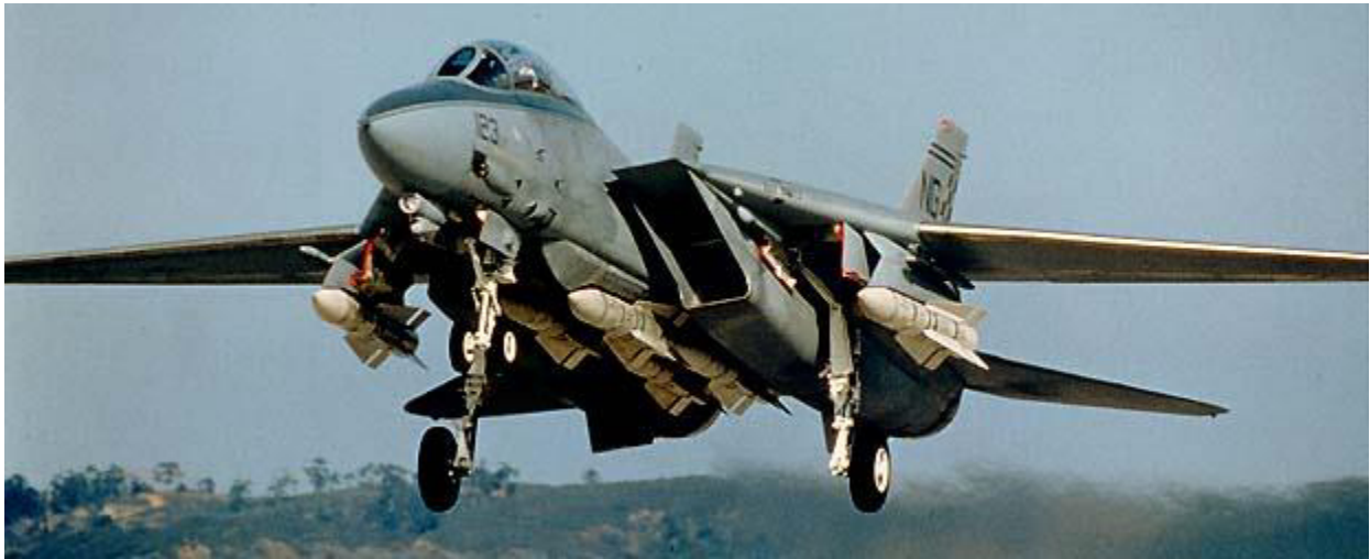
Figura 1-8. Grumman F-14 al momento de despegue con el ángulo de flechado mínimo en sus alas (Navy, 1970)
