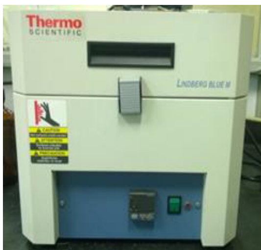
Figura 36. Horno tubular para la sulfurización de las películas delgadas.
