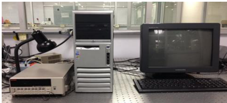
Figura 24. Sistema utilizado para la medición de la foto-respuesta; picoamperímetro (mod.6487), computadora y lámpara.
