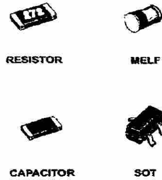
Fig.6.2 Algunos SMD comunes en el ensamblaje en la maquina FCM II.
