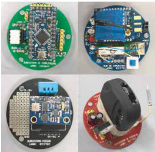
Figura 1. Configuración básica de los cuatro subsistemas de un cansat (elaboración de los autores).
