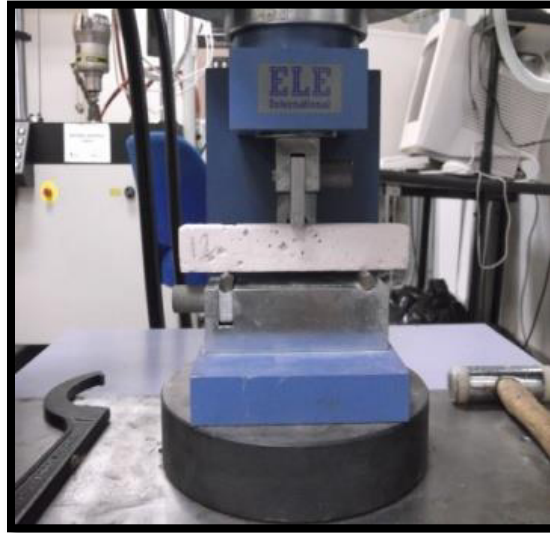
Figura 7 .Prueba de módulo de ruptura
