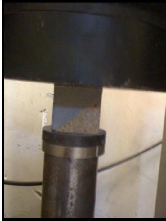
Figura 6. Prueba de compresión en frío
