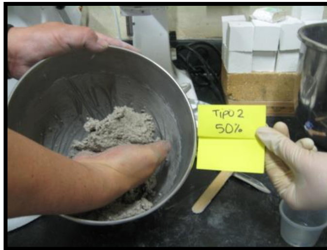
Figura 4. Muestra la prueba realizada del ball in hand del material A
