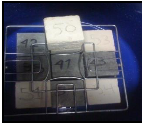
Figura 5 .Prueba de porosidad, en base a la norma los especímenes no pueden tocarse y debe existir cierta separación entre ellos como lo muestra la imagen.
