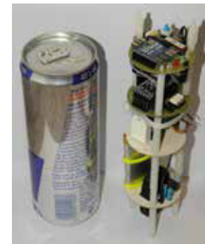
Figura 2. Ensamble del sistema, comparando su tamaño, con el de una lata de refresco.
