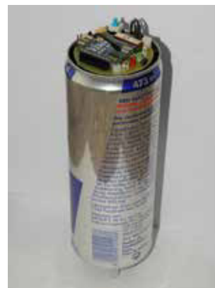
Figura 3. Sistema cansat completo, introducido en el interior de una lata de refresco.
