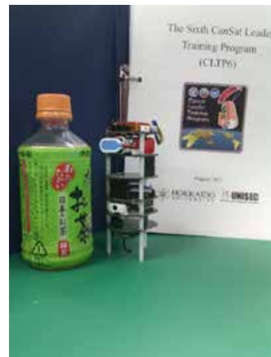
Figura 6. Modelo i-CanSat versión 6 listo para integrarlo en un envase de PET de 345 mL.
