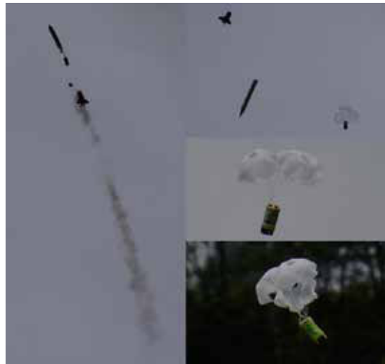
Figura 8. Etapa de separación del cohete a una altura aproximada de 100 m. Aquí se aprecia el despliegue de los tres paracaídas y el descenso del i-CanSat hasta unos instantes justo antes del aterrizaje.
