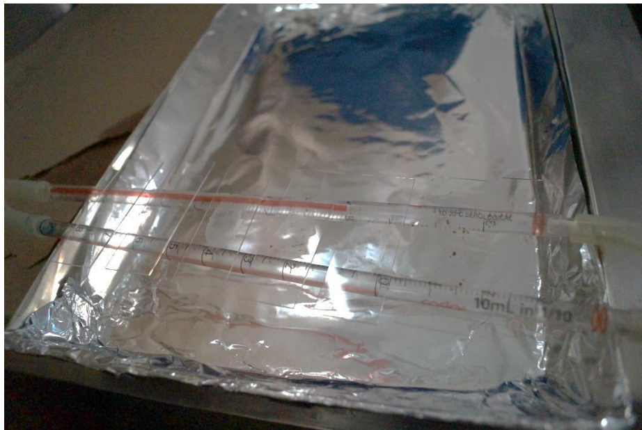
Figura 4.- Base para posicionamiento de laminillas. Utilizando una charola de metal, recubierta con aluminio. Sobre esta se colocaron 2 pipetas Pasteur a modo de que sostengan las laminillas y a su vez las mantengan niveladas, evitando el escurrimiento de lo que en ellas se depositaría.
