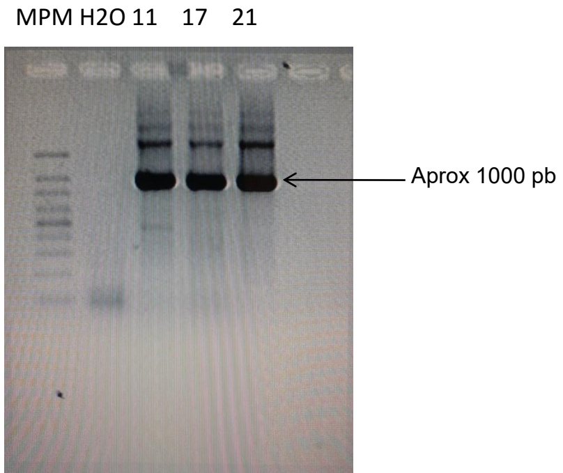
Figura 29.- Electroforesis en Gel de agarosa al 1% teñido con bromuro de etidio. MPM corresponde a marcador de peso molecular 100 pb DNA Ladder
