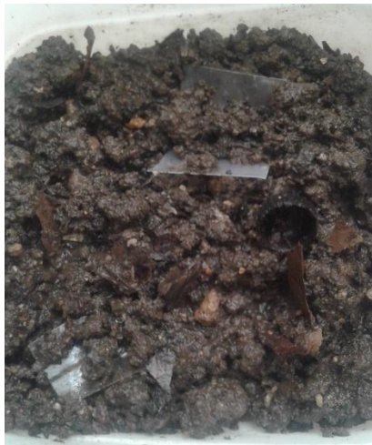
Figura 34.- Biodegradación del producto generado por la cepa 21D frente al PET.
