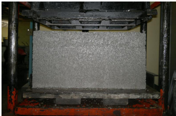
Figura 25. Bloque de mampostería a punto de ser retirado de la máquina bloquera.
