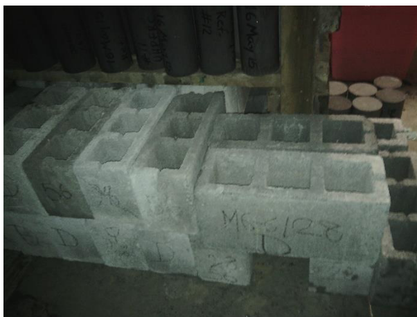
Figura 99. Especímenes de mampostería en el ciclo de humedecimiento.
