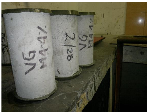
Figura 28. Cilindros de 100x200 mm cabeceados con azufre.
