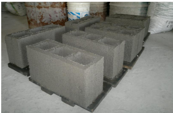
Figura 26. Especímenes de mampostería después de la fabricación durante su fraguado inicial.
