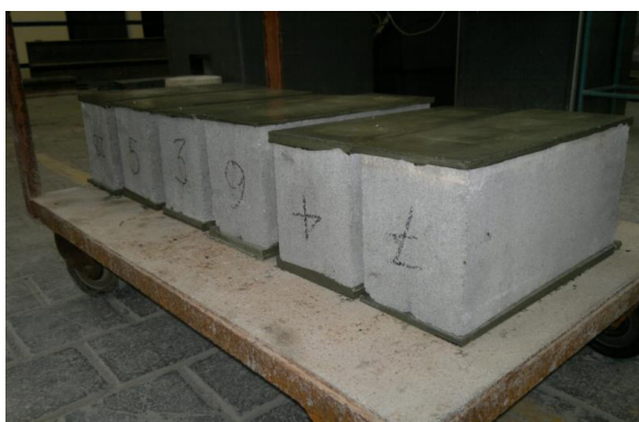
Figura 27. Especímenes de mampostería para ensayo a compresión.
