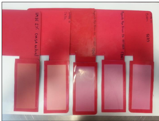
Figura 50. Placas de PVC después de salir de la prueba de intemperismo. [50]
