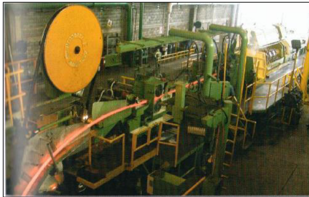
Figura 19. Imagen de colada continua Properzi 1980 [19].
