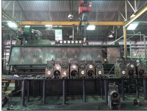
Figura 18. Imagen de herramental de colada continua ICV [18].
