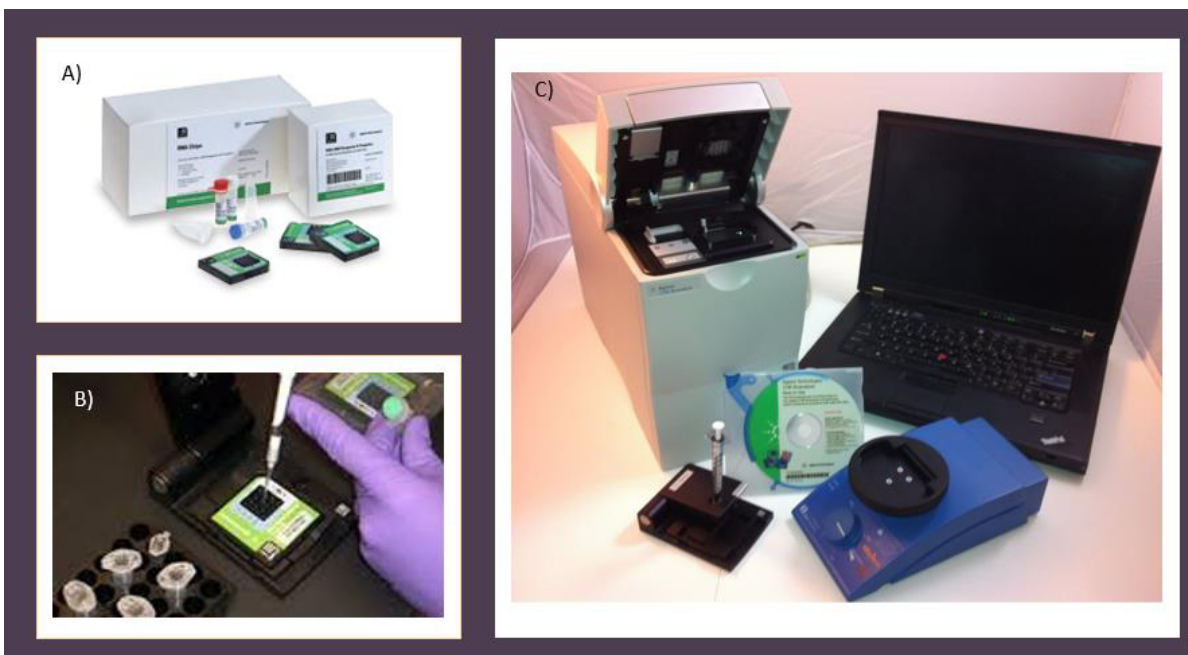
Figura 6. Reactivos, equipos y consumibles utilizados para Agilent RNA 6000 Nanokit-2100 Bioanalyzer System. A) Se muestran todos los reactivos utilizados para la elaboración del Chip. B) Se muestra una imagen representativa de cómo se cargaban las muestras en el RNA-chip. C) Se muestran los equipos utilizados en este sistema: el Bioanalyzer en color blanco, el vórtex utilizado en la preparación del Chip de color azul y la estación de cebado ( priming station ) que corresponde a la jeringa que se observa en la imagen.
