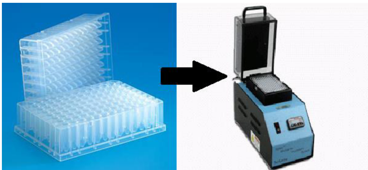
Figura 10. Placa MIDI y equipo Hybrix. La placa MIDI está diseñada para que el fondo de cada uno de los pozos alcance la temperatura óptima en el equipo Hybrix. Realizamos este procedimiento con el objetivo de que se lleve a cabo el proceso de ligación-extensión, este consiste en que después de que son alineados los primers a las secuencias complementarias de interés, se agregan los nucleótidos complementarios a la secuencia blanco mediante la extensión obteniendo de esta manera el tamaño de fragmento esperado para cada gen.
