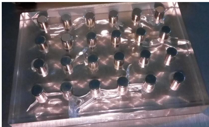
Figura 9. Soporte magnético para placa MIDI 24 pozos marca Ambion. El soporte magnético está diseñado de una base de acrílico y en lugares correctamente posicionados, imanes fuertes que permiten realizar lavados con perlas magnéticas de las librerías, durante el protocolo de TruSeq Target RNA.
