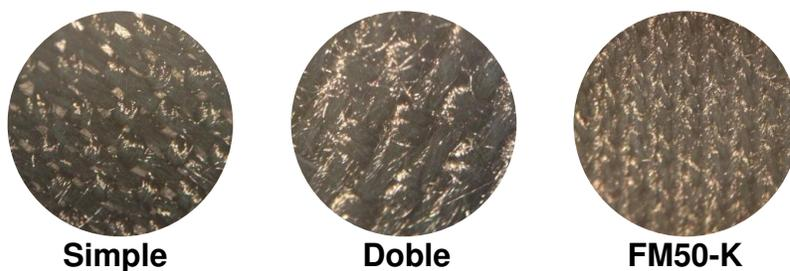
Figura 5. Fotografías tomadas con estereoscopio de los distintos materiales carbonáceos
