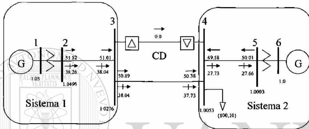
Figura 5.6. Línea de cd transmitiendo 0 MW en paralelo con línea de ca.
