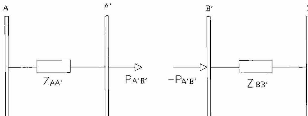
Figura 4.2. Flujo a través del BTB modelado como inyecciones de potencia en los nodos conectados al BTB.
