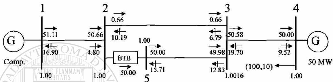
Figura 5.19. BTB en paralelo transmitiendo 50 MW en MCV.
