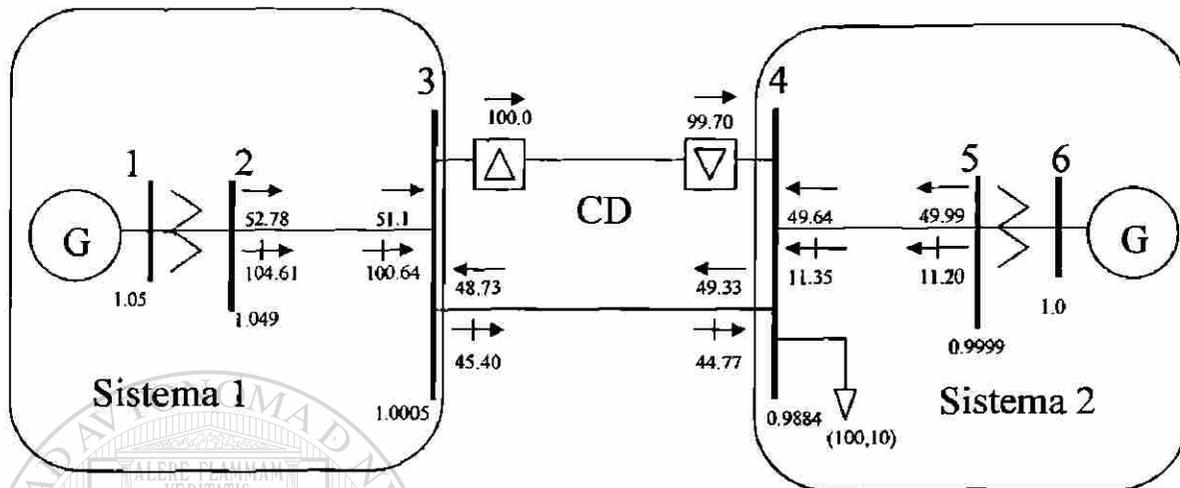
Figura 5.14. Línea de cd transmitiendo 100 MW. Se usa el método PCD-QCD
