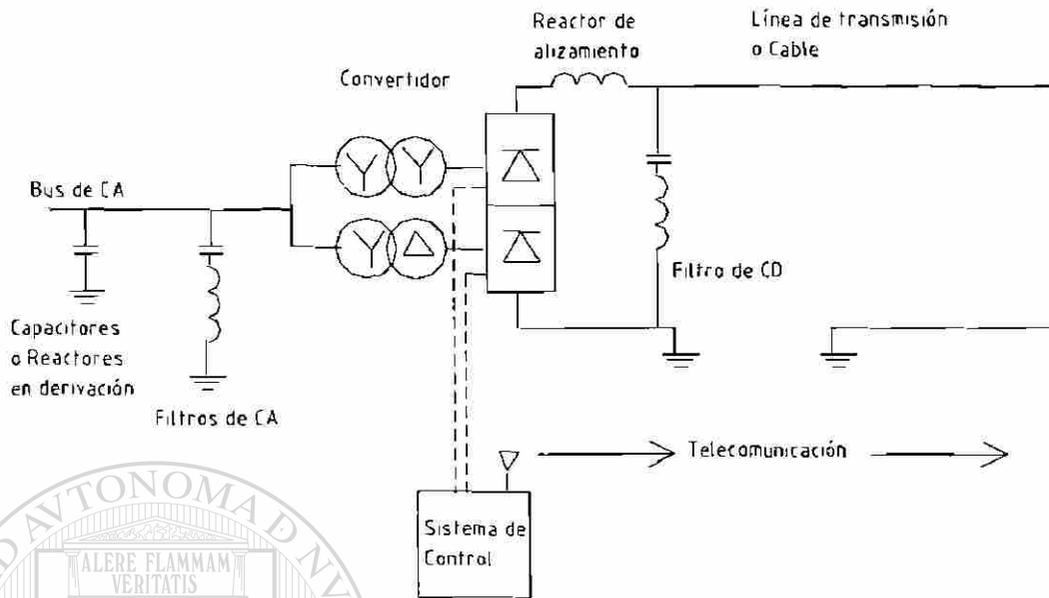
Figura 2.3. Estación convertidora HVDC.
