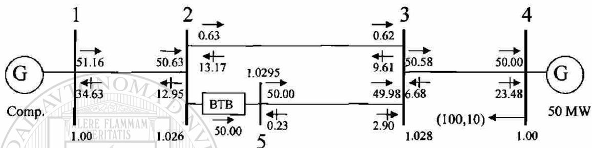
Figura 5.17. BTB en paralelo transmitiendo 50 MW en MCP.
