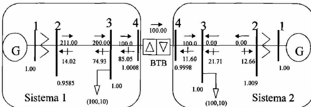
Figura 5.27. BTB transmitiendo 100 MW en MCV.
