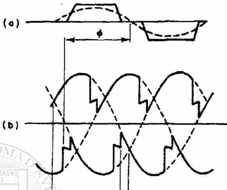
Figura A.5. Formas de onda del inversor. (a) Corriente alternando; (b) Formas de onda del voltaje de  $cd$
