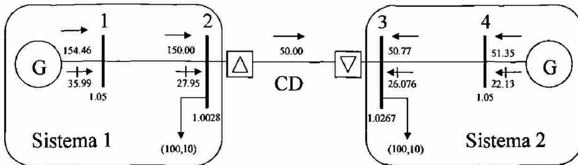
Figura 5.3 Línea de cd transmitiendo 50 MW.
