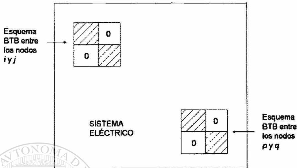
Figura 4.6. Jacobiano incluyendo dos esquemas BTB en el estudio de flujos de potencia.
