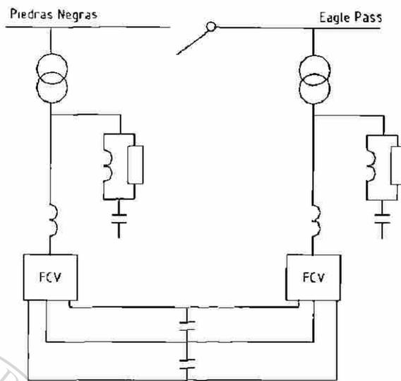
**Figura B.2.** Diagrama unifilar del BTB de Eagle Pass de 138 kV y 36 MVA.
