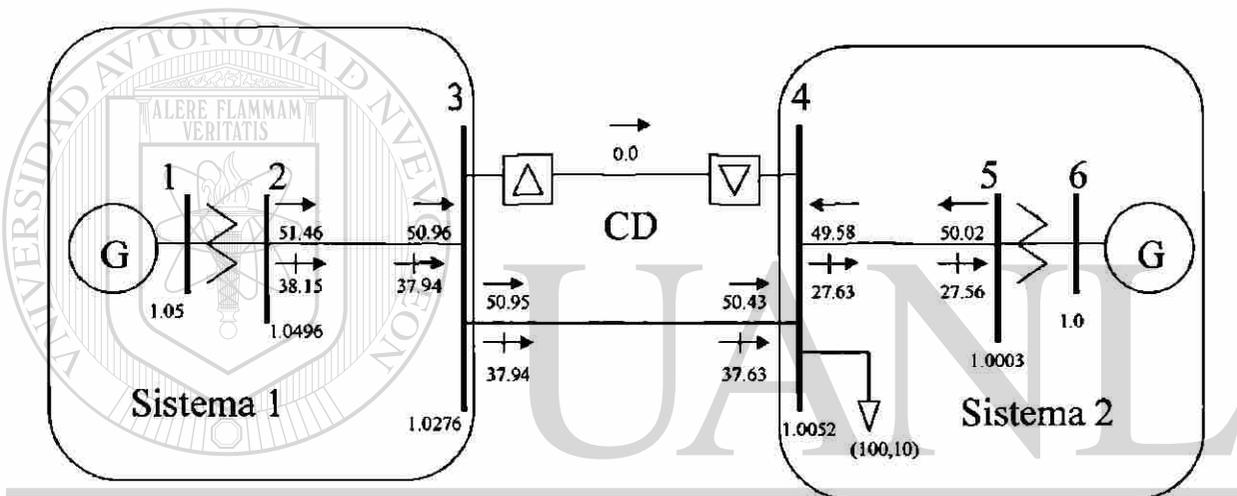
Figura 5.12. Línea de cd transmitiendo 0 MW. Se usa el método PCD-QCD
