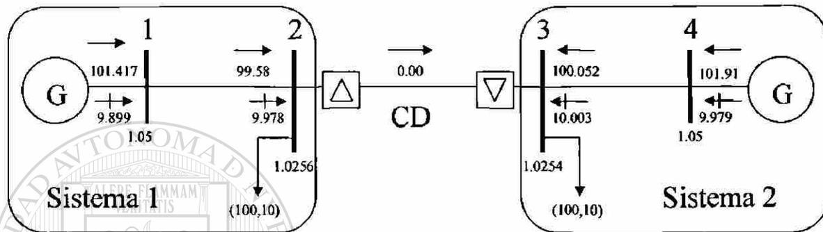
Figura 5.2 Línea de cd transmitiendo 0 MW.
