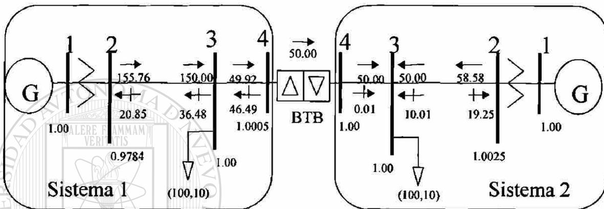
Figura 5.26. BTB transmitiendo 50 MW en MCV.
