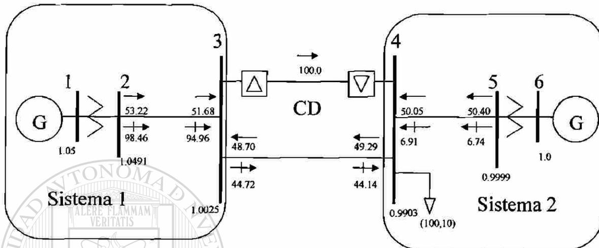
Figura 5.8. Línea de cd transmitiendo 100 MW en paralelo con línea de ca
