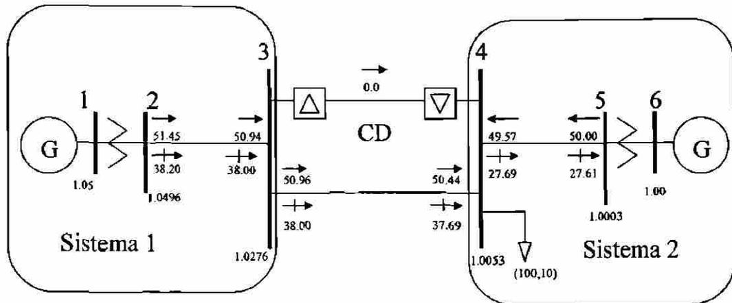
Figura 5.9. Línea de cd transmitiendo 0 MW. Se usa el método P-QCD.
