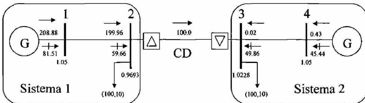
Figura 5.4 Línea de cd transmitiendo 100 MW
