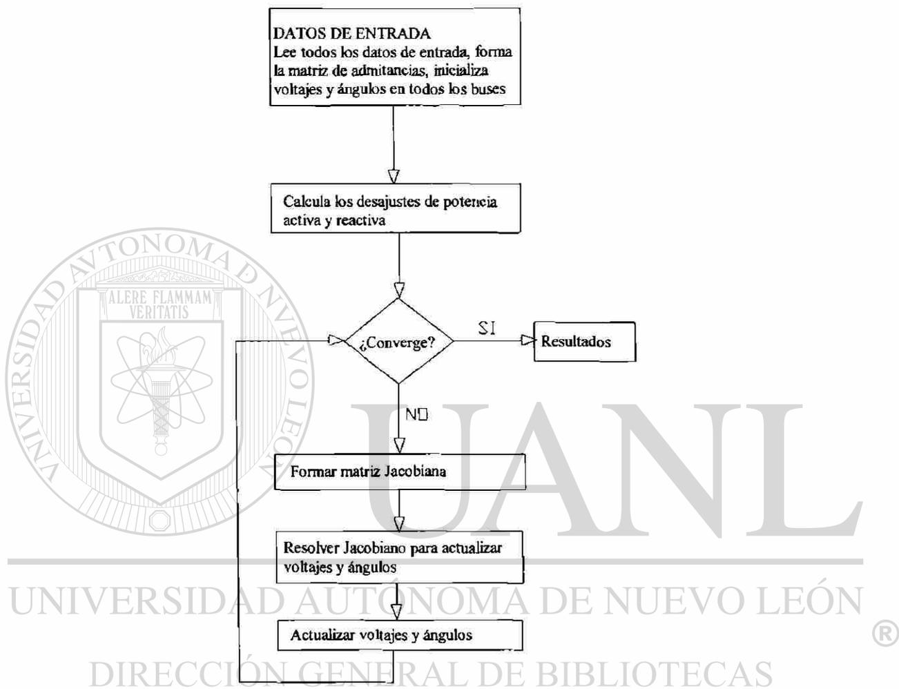
Figura 3.2. Diagrama de bloques del algoritmo básico de flujos de potencia usando el método Newton-Raphson
