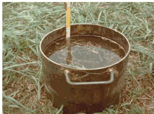
Figura 3.7. Infiltrómetro de un anillo hincado en el suelo, midiéndose el descenso del agua.
