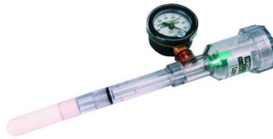
Figura 3. 5. Fotografía de un tensiómetro para determinar la humedad en el suelo.
