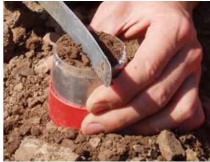
Figura 4.5. Fotografía adquiriendo una muestra de suelo, utilizando el método de cilindro.
