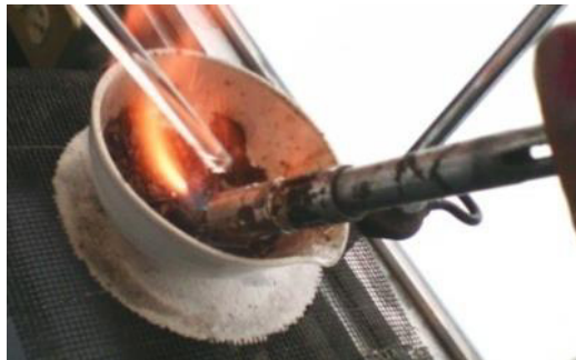
Figura 3. 18. Fotografía secado el suelo con alcohol encendido.
