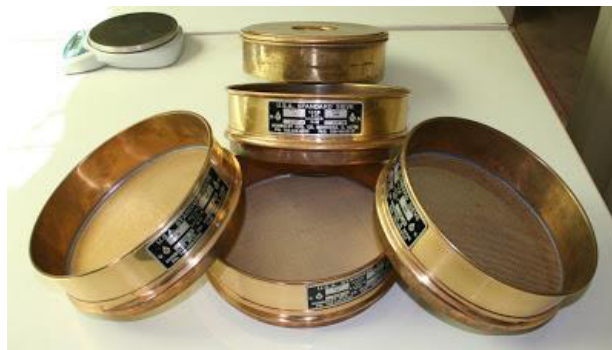
Figura 3. 12. Fotografía de cribas utilizadas para determinar la granulometría en muestras de suelos.
