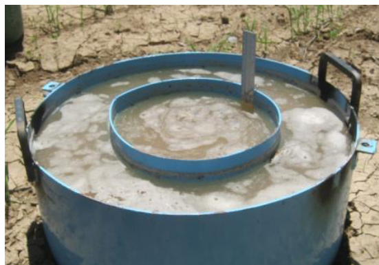
Figura 4.3. Fotografía de la colocación del infiltrómetro de doble anillo en una área de uso agrícola de tipo de suelo vertisol (sin materia orgánica en el interior de los cilindros para evitar una lectura errónea en la información).
