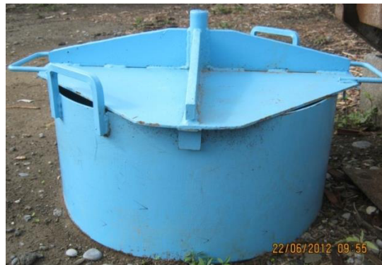
Figura 3.8. Fotografía del infiltrómetro de doble anillo terminado con su tapa, la cual sirve para golpearlo en la parte central para que pueda hincarse en el suelo, así como con estructuras (agarraderas) para tomarlo con mayor facilidad para su manejo.
