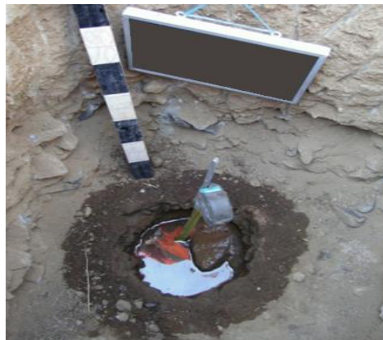
Figura 3.9. Fotografía de un hoyo cilíndrico en el suelo lleno de agua (método de Porchet), midiendo el descenso de la misma para determinar la infiltración.
