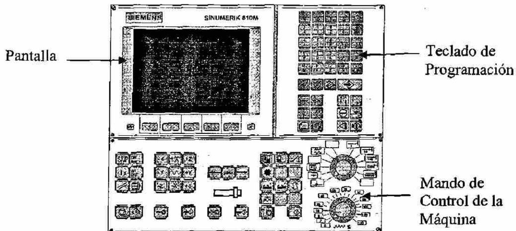
Figura 47. Panel básico de un sistema CNC
