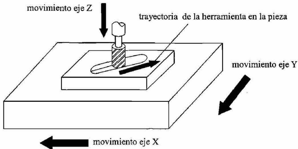
Figura 12. Generación de una trayectoria de herramienta
