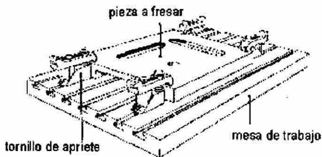
Figura 23. Mesa de fresadora con tornillos de apriete
