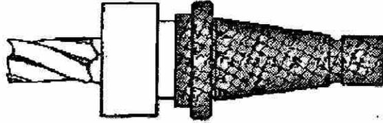
Figura 34. Acoplamiento para fresadoras
