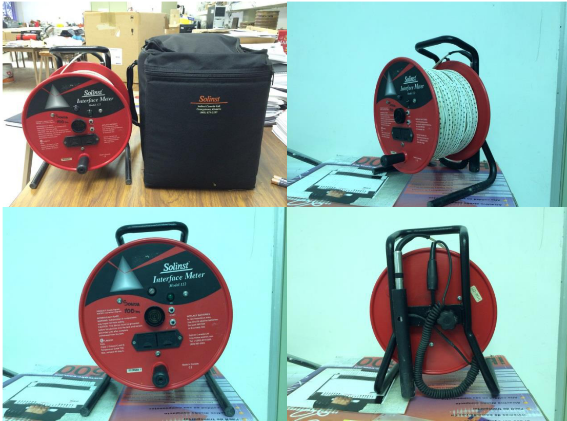
Figura 4.5 Sonda hidrogeológica Solinst de 100 m del Laboratorio de Ingeniería Geológica e Hidrogeología
