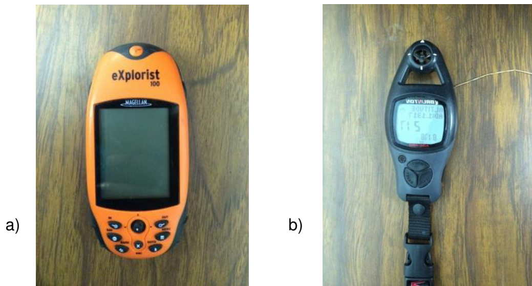
Figura 4.4. Instrumentos utilizando en campo para la medición de pozos a) GPS (Magellan), b) Altímetro de precisión (SOKIA)
