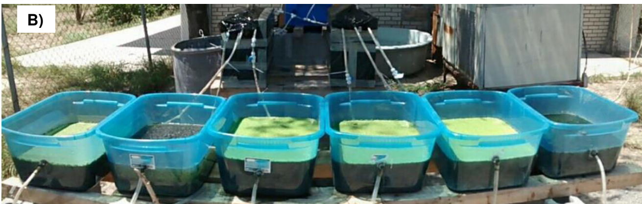
Figura 3. A) esquema del sistema de tratamiento de aguas residuales. Se muestran los tratamientos utilizados dentro del sistema. Agua residual sin tratar (1), RAB con neumático automotriz triturado (2) y las descargas de sus reactores aerobios (4, 6 y 8). RAB sin sustrato de fijación de biopelículas (3) y las descargas de sus reactores aerobios (5, 7 y 9). B) fotografía del sistema híbrido de tratamiento de aguas residuales.
