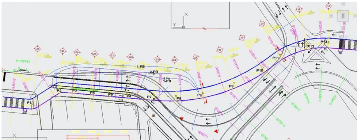
En la figura 6.14 se muestran la ubicación de todos los puntos de medición con los ejes correspondientes, desarrollados para la instrumentación. En total se tienen 14 puntos, uno para cada apoyo. Los puntos se nombraron “P” seguidos de un número correspondiente de identificación (de 1 a 13, y B)
