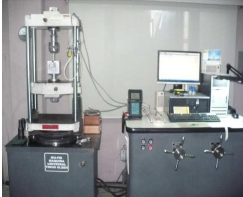
Figura 3.3 Maquina universal para ensayos de tensión
