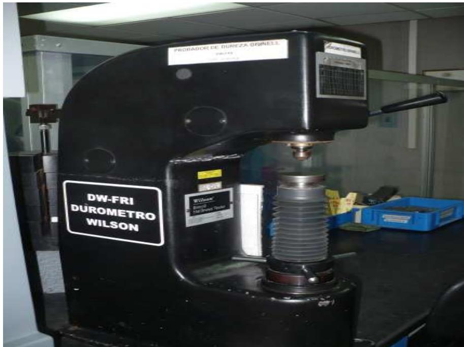
Figura 3.5 Maquina de ensayos de dureza
