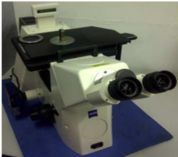
Figura 3.6 Microscopio óptico Zeiss, Modelo AXIOVERY 200 MAT
