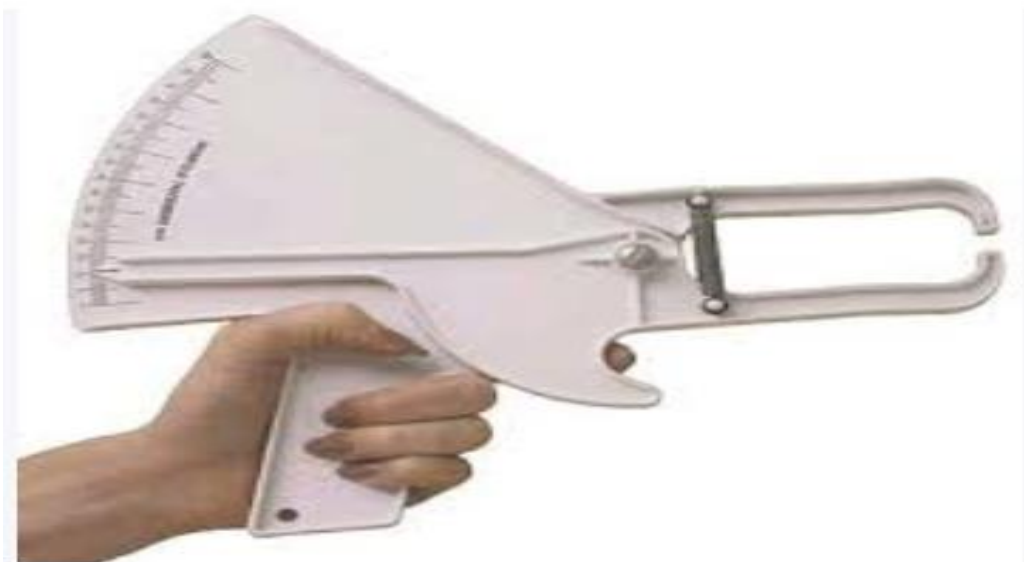
Figura 15. Calibrador de pliegues cutáneos (Plicómetro). Tomado de nutriologosenred.com/los-plicometros-y-sus-diferencias-un-analisis-de-sus-funciones-usos-y-costos/
