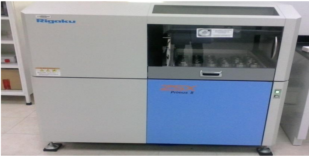
Figura 2.3 Determinación de composición elemental por fluorescencia de rayos X
