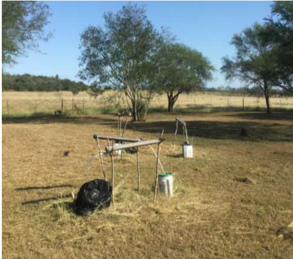
Figura 11. Canaletas de PVC instaladas para medir la precipitación Incidente.
