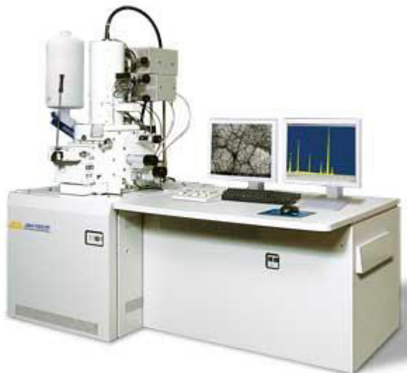
Figura 24. Microscopio electrónico de barrido marca Nova NanoSEM 200, FEI Company con Espectro de Energía Dispersiva de Rayos X marca INCA X-Sight EDS detector.
