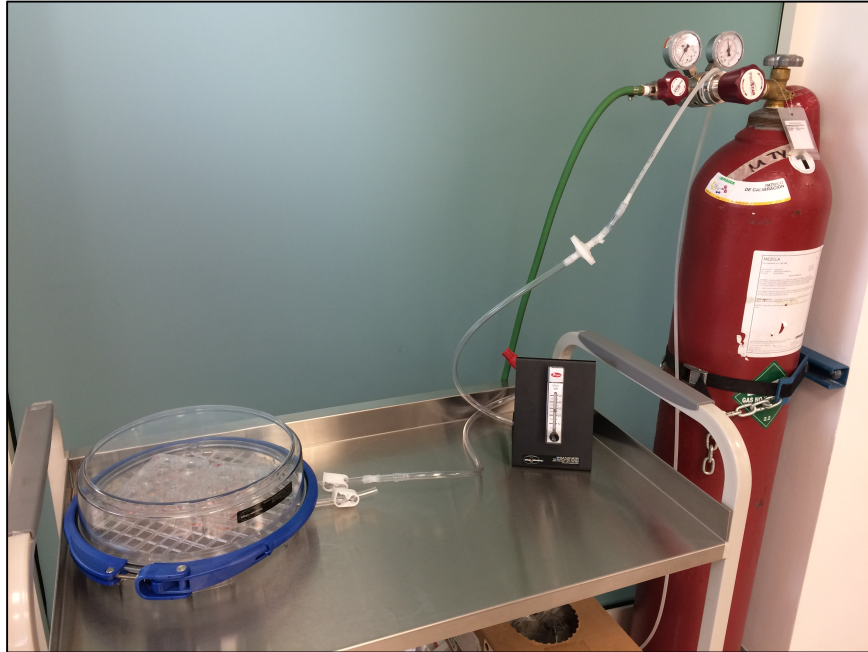
Figura 5. Cámara de hipoxia (foto tomada del laboratorio UG-CIDICS). En la figura se observa la cámara sellada unida a un regulador de presión y al tanque de la mezcla de gases (94% nitrógeno, 5% dióxido de carbono y 1% oxígeno).
