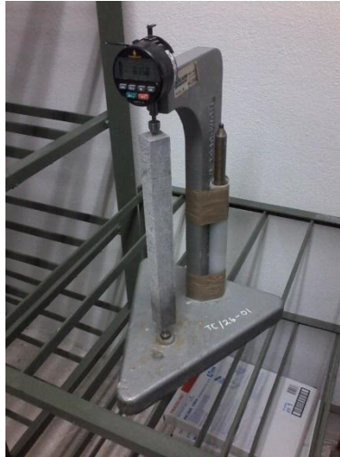
Figura 3.20 Medición de expansión en barras de mortero para determinación de RAS en comparador de longitud con barra de referencia metálica.
