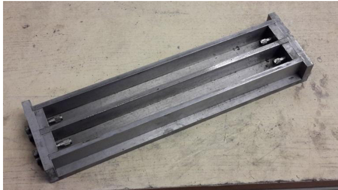
Figura 3.18 Molde de probetas de mortero para determinación de la reactividad álcali-sílice (RAS)
