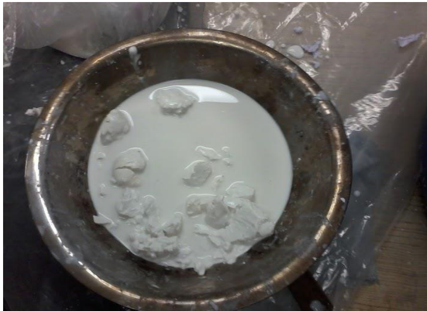
Figura 4.3 Cullet de Borosilicato molido en húmedo por 60 minutos en un molino rápido de tipo planetario.
