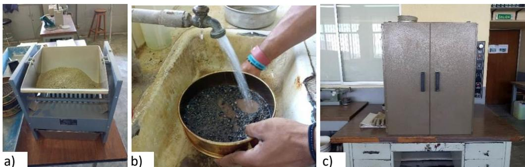
Figura 22. a) cuarteo mecánico; b) lavado de muestra; c) secado en el horno.
