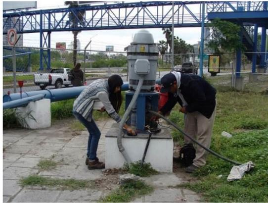
Figura 17. Medición de los niveles estáticos con sonda acústica Solinst en pozo Suachiate II.
