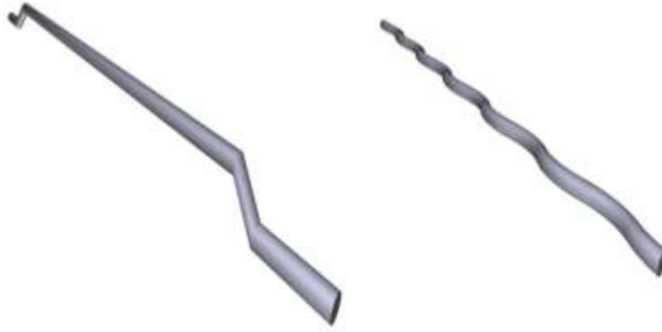
FIGURA 8. Formas y tipos comunes de fibras de acero, tomada de [Orbe et al, 2015].
