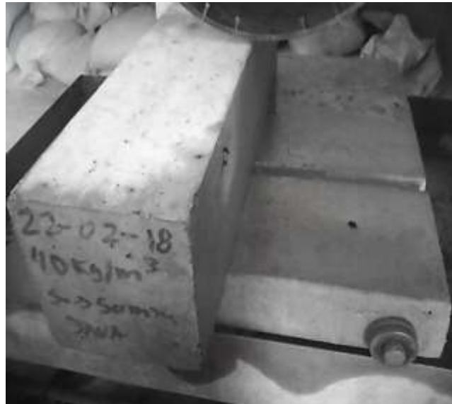
Figura 43. Espécimen prismático antes de ser sometido al procedimiento de ranurado en húmedo.
