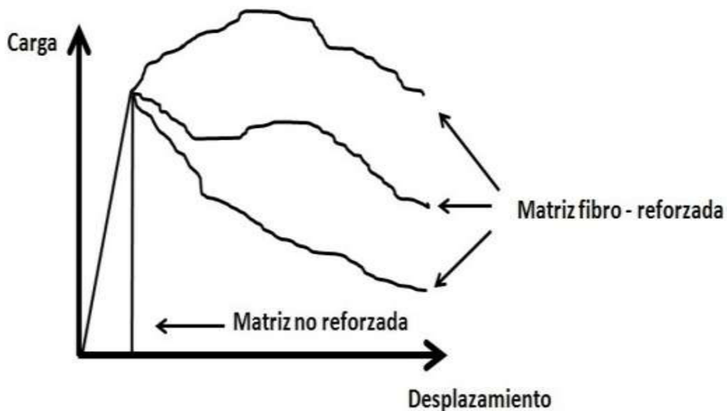
FIGURA 9. Curva carga deflexión Concreto normal Vs CRFA, adaptada de [ACI 544.1R-96, 2002; Orbe et al, 2015].
