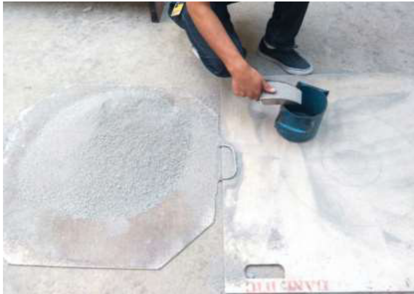
Figura 25. Determinación del PVSS del agregado fino
