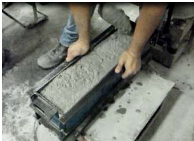
Figura 31. Llenado y vibrado de uno de los especímenes fabricados.
