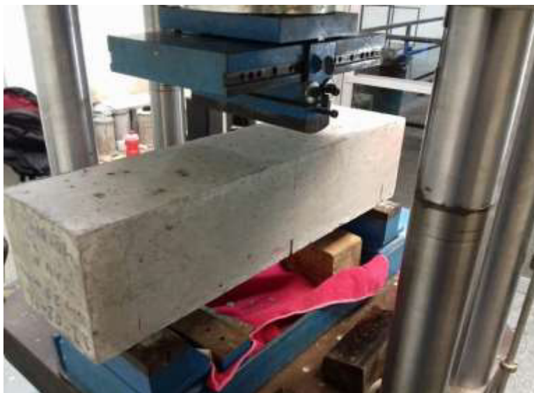
Figura 36. Especimen prismático antes de ser sometido a la prueba a flexión de 3 puntos (3PB).
