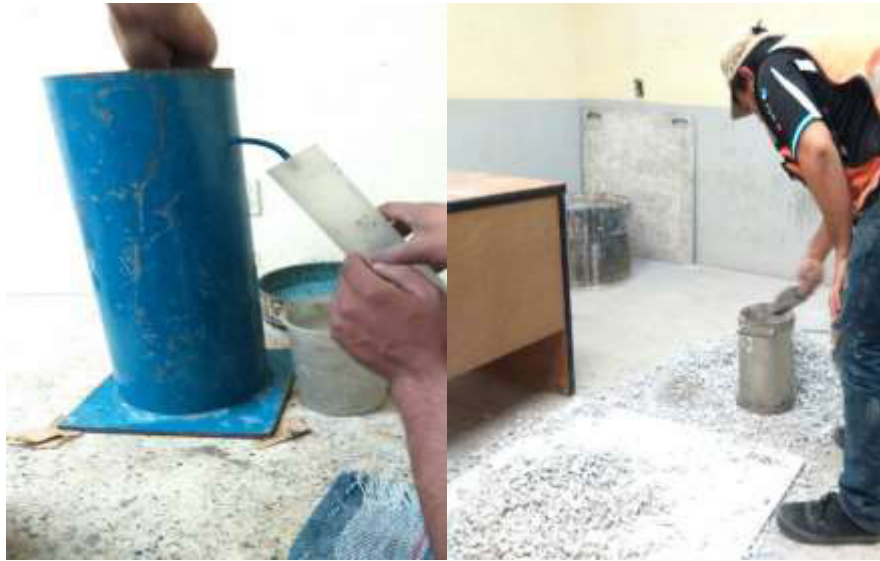
Figura 24. Caracterización del agregado grueso a) determinación de la masa específica (densidad), b) determinación del PVVS.
