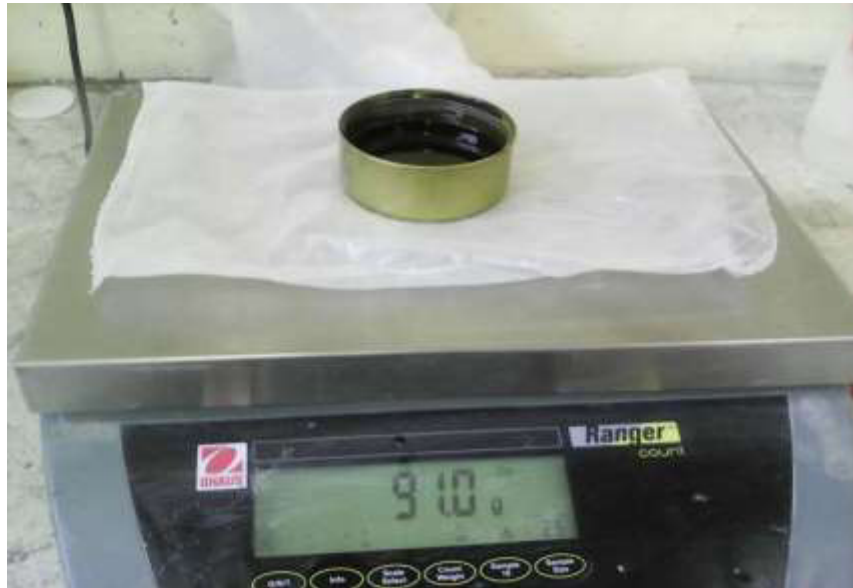
Figura 27. Pesaje de la muestra de aditivo antes de ser ingresada al horno.
