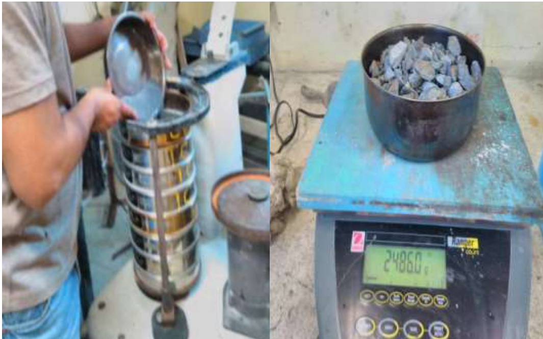
Figura 26. Análisis granulométrico de los agregados. a) agregado fino antes del tamizado, b) pesaje de la muestra de agregado grueso a ser analizada.
