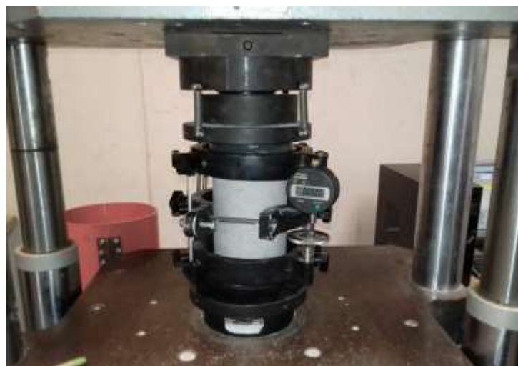
Figura 34. Especimen cilíndrico de la serie I, siendo sometido a la prueba de módulo de elasticidad.
