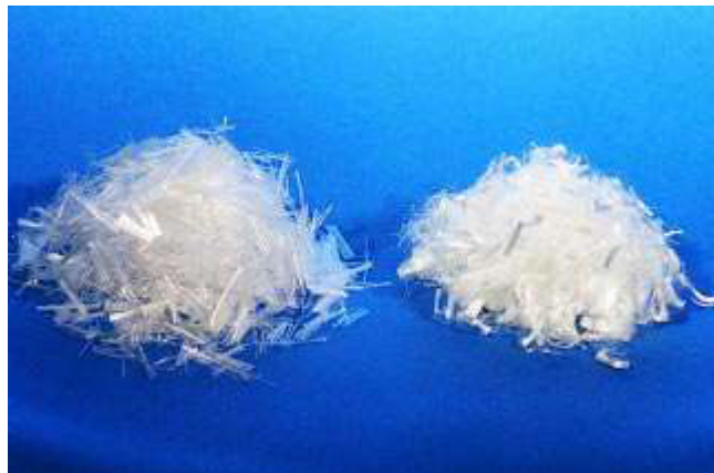
FIGURA 6. Fibras de polipropileno, tomada de [Kosmatka et al, 2004].
