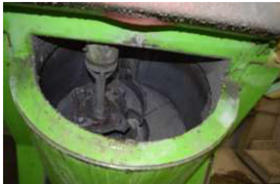
Figura 29. Mezcladora de flujo inverso utilizada.
