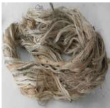
FIGURA 4. Fibra de jute, tomada de [Zakaria et al, 2016].
