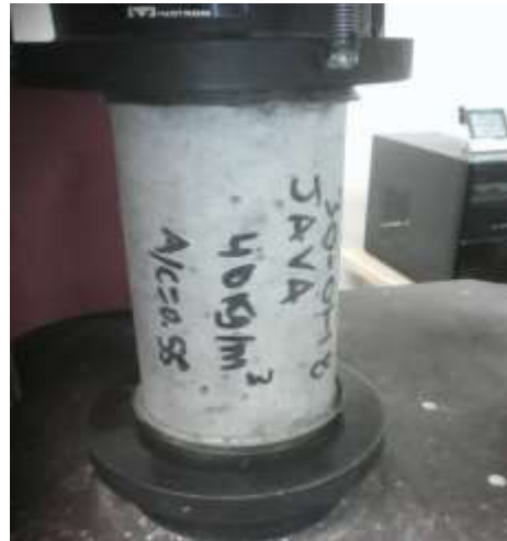
Figura 33. Ensaye a compresión realizado en un espécimen de la serie II.
