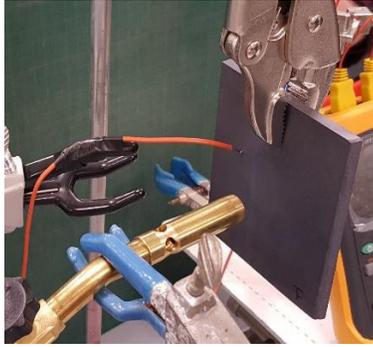
Figura 3.5. Posición de los termopares en la parte frontal.
