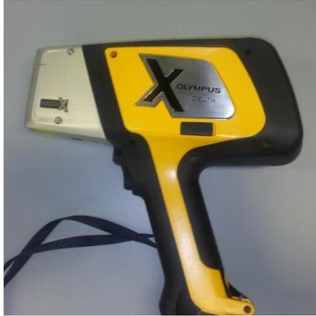
Figura 3.3. Equipo de fluorescencia de rayos x.
