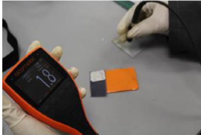
Figura 4.1. Medición del espesor por medio de Ultrasonido.
