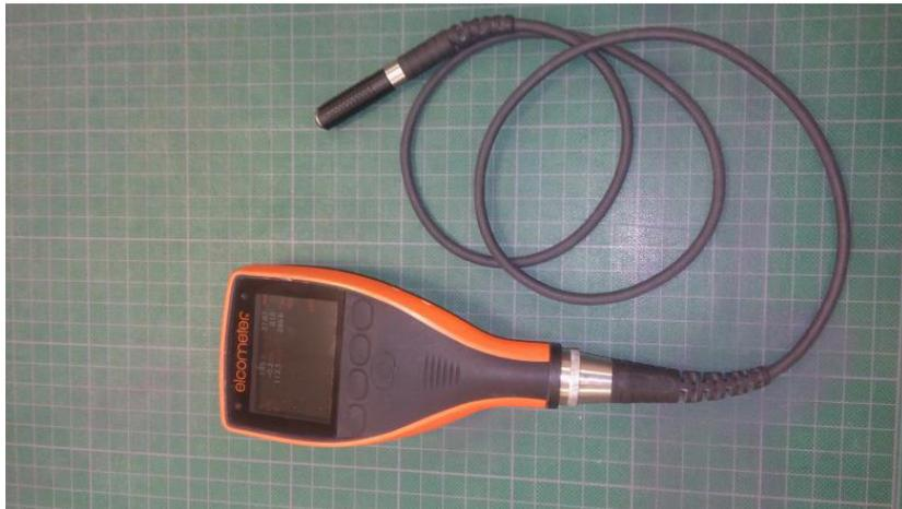
*Figura 3.2. Equipo Elcometer para medición de espesores.*
