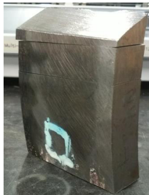
C) Soldadura con agrietamiento
