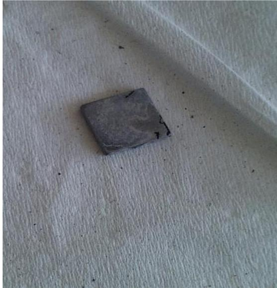
E.5 Muestra del acero a 800°C en vapor de agua durante 5 minutos de exposición después del decapado.
