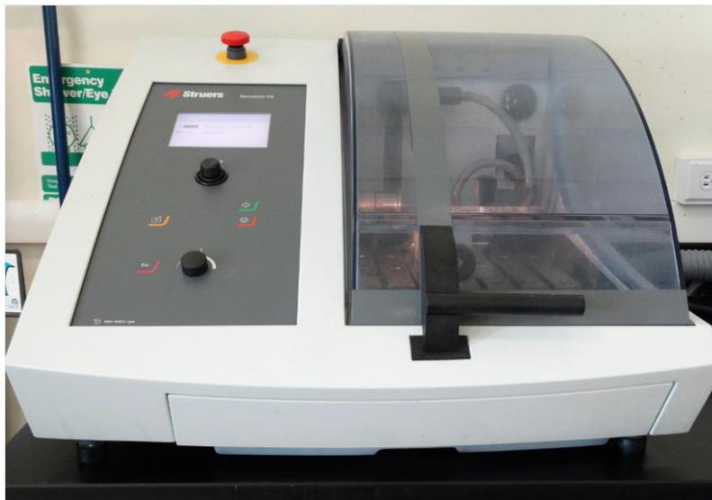
Figura 3.10 Cortadora automática STRUERS® ACCUTAN 5 utilizada.
