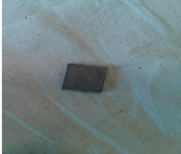
E.1 Muestra del acero a 800°C en aire seco durante 5 minutos de exposición después del decapado.
