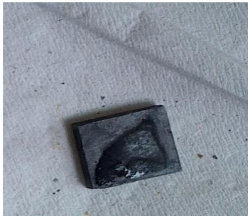
E.8 Muestra del acero a 1000°C en vapor de agua durante 25 minutos de exposición después del decapado.
