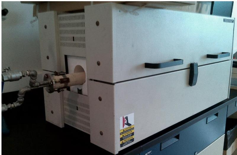
Figura 3.7 Horno de tipo tubular utilizado para las pruebas de oxidación.
