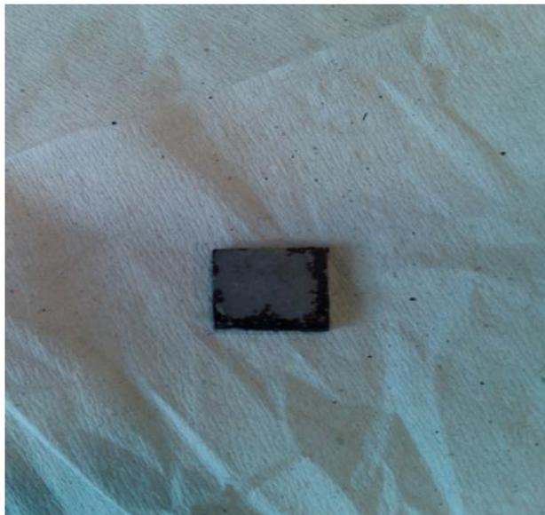
E.2 Muestra del acero a 800°C en aire seco durante 25 minutos de exposición después del decapado.
