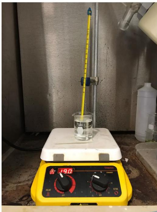
Figura 3.13 Equipo utilizado para el decapado.
