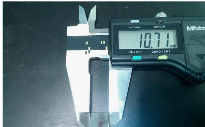
Figura 3.3 Dimensión de los especímenes para las pruebas.
