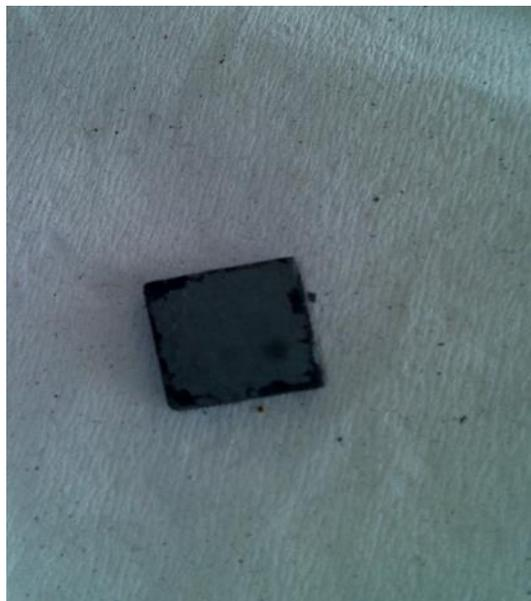
E.6 Muestra del acero a 800°C en vapor de agua durante 25 minutos de exposición después del decapado.
