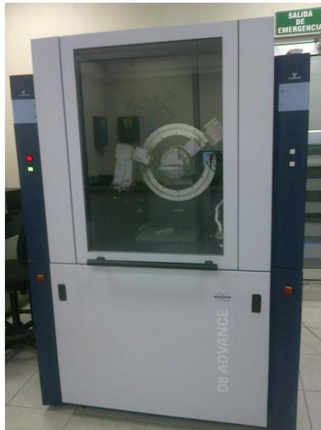
Figura 3.11 Difractómetro utilizado marca Bruker D8 Advanced.
