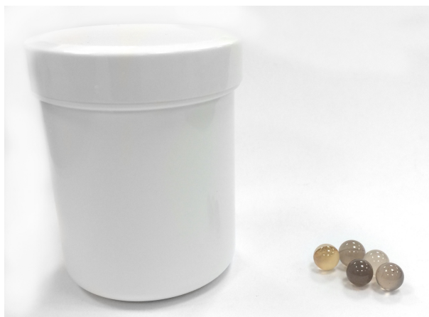
Figura 3.2: Viales de polipropileno y bolas de ágata utilizadas para homogeneizar la mezcla de polvos.
