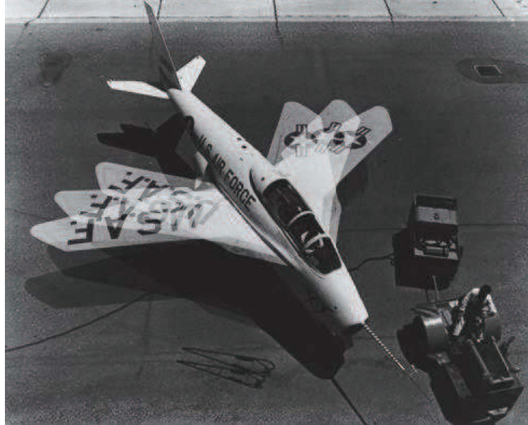
Figura 2. Aeronave con ángulo de flechado variable Bell X5 [5].
