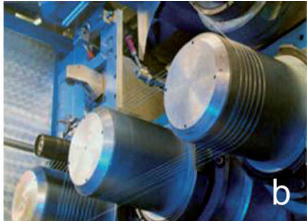
Fig. 4. a) Fotografía de la tobera de hilar, b) Fotografía de los cilindros estirados para filamentos sintéticos.
