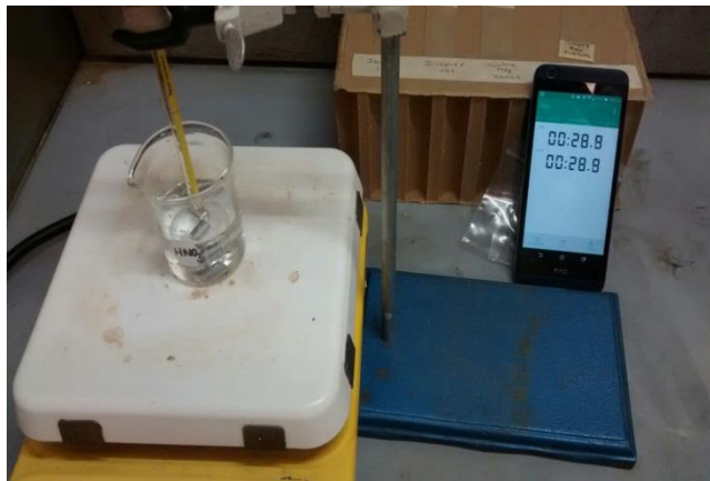
Figura 3.4 Tratamiento de pasivación
