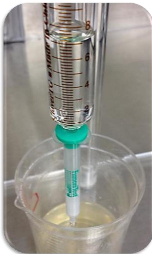
**Figura 7. Utilización de CIA FumoniTest<sup>™</sup> Vicam<sup>®</sup> (Waters Co.) para la purificación de FBs de las muestras de forraje.**
