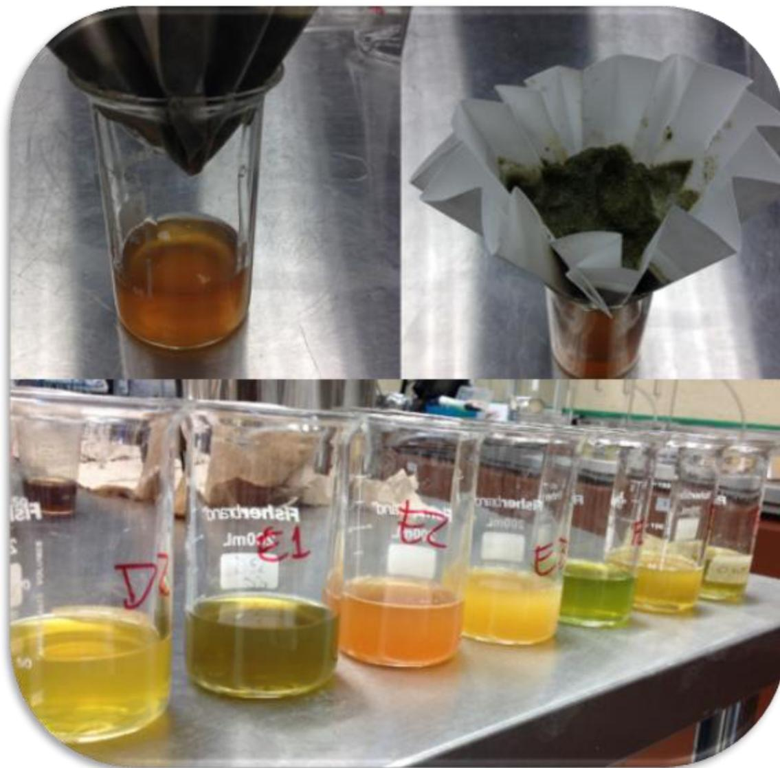
**Figura 6. Extracción y filtración de FBs en las muestras una vez procesadas y homogenizadas con el solvente, utilizando filtros acanalados Vicam®.**
