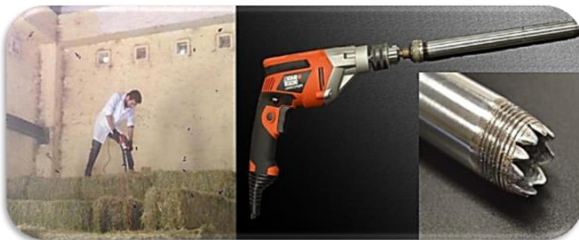
**Figura 4. Toma de muestras en los diversos hípicas (izquierda), utilizando un taladro con sacabocado (derecha) para la perforación en ángulo de 90° de las pacas de forraje henificado.**
