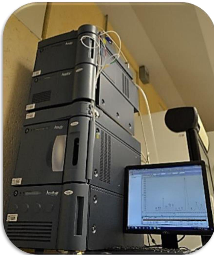
**Figura 8. Sistema ACQUITY UPLC H-Class (Waters Co.) utilizado para la detección de FBs por medio de fluorescencia.**
