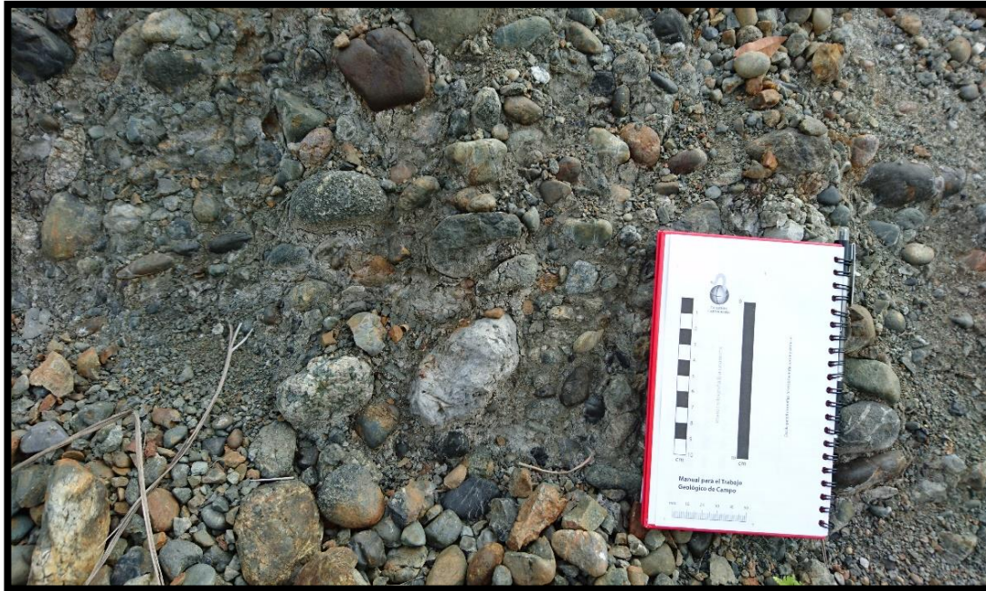
Figura 5.3. Conglomerado, de grano tamaño grava, con textura clasto-soportada. Se aprecian las diferentes litologías presentes y el variado tamaño de clasto (Facies A2).
