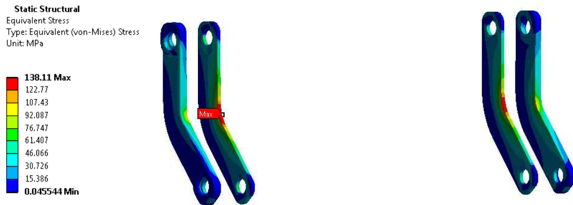
Figura 7.10. Resultado del esfuerzo equivalente obtenido en el sexto caso de carga (brazo guía).
