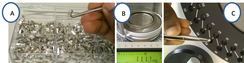
Figura 28. Preparación de muestras para análisis elemental: A) Bote de lata, B) Muestra enrollada en bote de lata, en pelota hermética y pesada, C) Colocación de las pelotas en equipo CHN Analyzer
