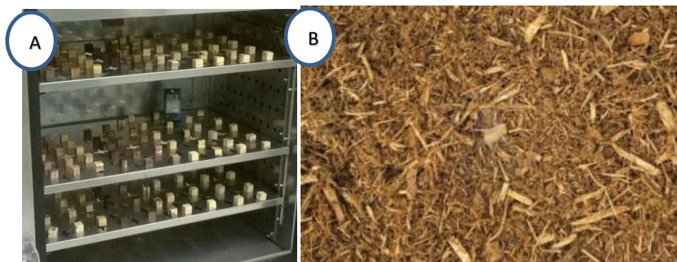
Figura 22. Preparación de muestras: A) Acondicionamiento de probetas en la cámara, B) Secado de astillas al aire
