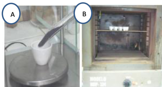
Figura 26. Determinación del contenido de humedad: A) Toma de muestra, B) Secado en estufa
