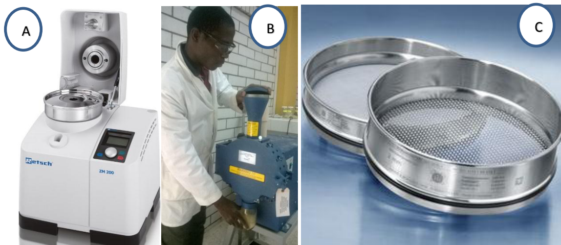
Figura 24. Preparación de muestras mediante: A) Molinado del carbón vegetal, B) Molinado de astillas y hojas secas, C) Tamices de mallas 40 y 60
