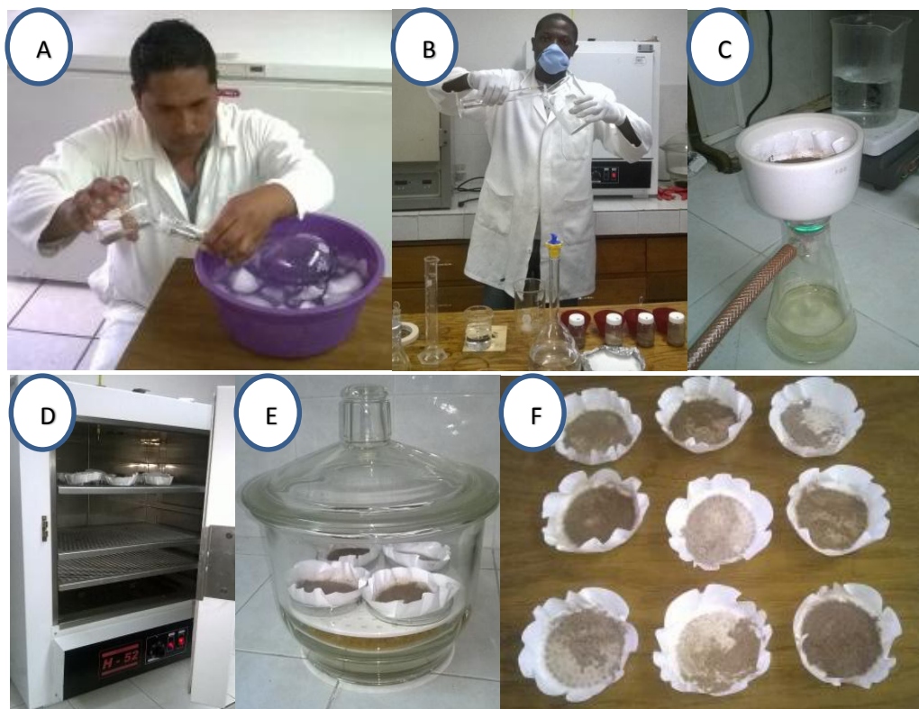
Figura 34. Determinación del contenido de lignina. A) Preparación de las soluciones \text{H}_2\text{SO}_4 y \text{HBr} , B) Adición de ácidos a la muestra de harina, C) Filtraje de extraíbles y lavado de residuos de ácidos, D) Secado en horno, E) Desecador con muestras de lignina, F) lignina
