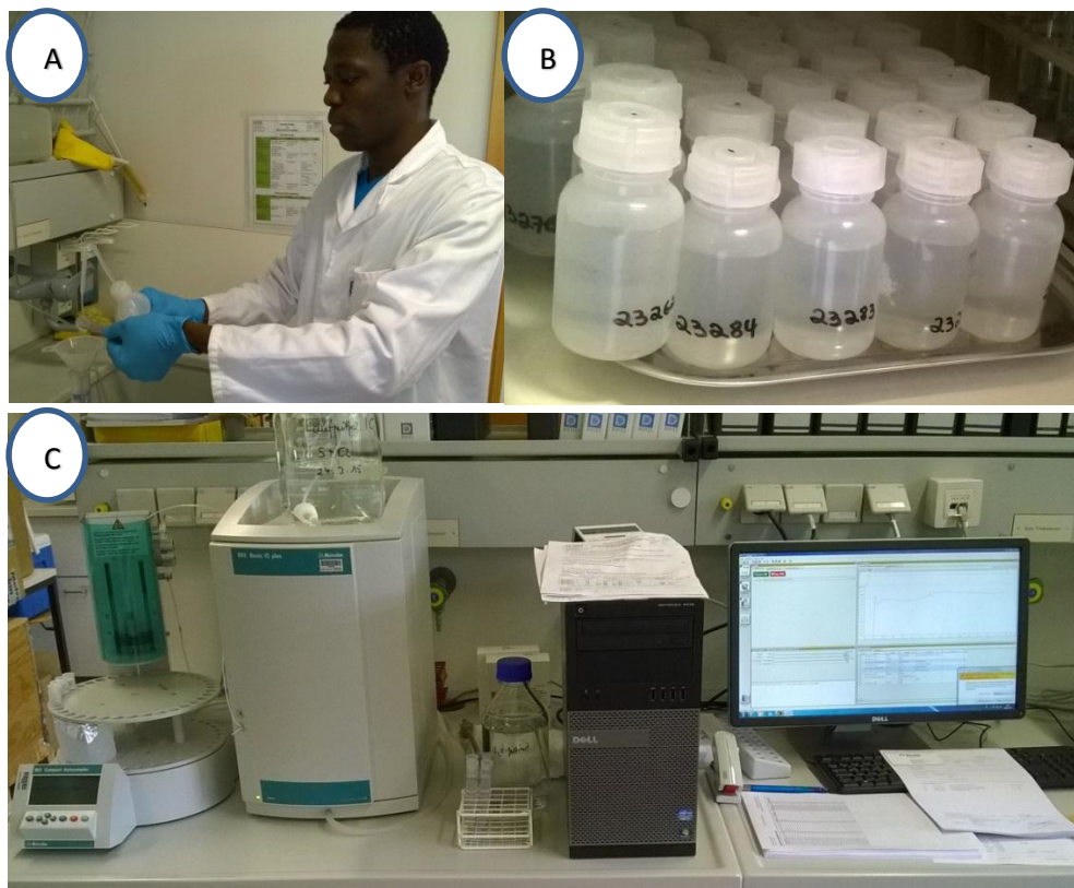
Figura 37. Análisis de los residuos postcombustión A) Recuperación y dilución de los residuos, B) refrigeración de las soluciones diluidas; C) Cromatografía iónica y registro de datos
