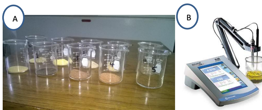
Figura 35. Determinación del pH: A) Muestras en vasos de precipitados, B) lectura en potenciómetro
