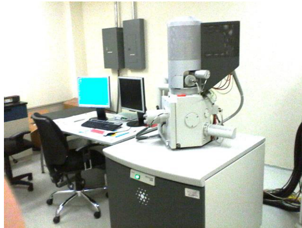
Figura 2.13. Equipo de Microscopía Electrónica de Barrido Nova NanoSEM 200 del CIIDIT de la UANL.
