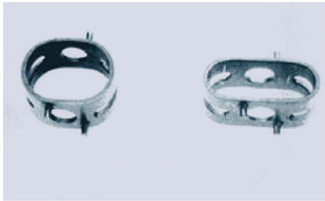
Figura 1.13. En (a) se muestra un espaciador de la columna vertebral en estado martensítico y austenítico [75].
