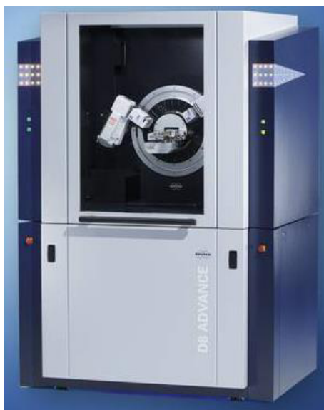
Figura 2.12. Equipo de difracción de rayos-x Difractómetro Bruker Advanced Solutions D8.
