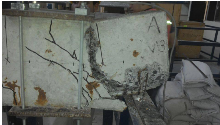
Figura 57: Falla por adherencia
