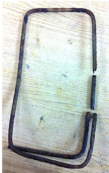
Figura 31: Pérdida de masa y sección del estribo.
