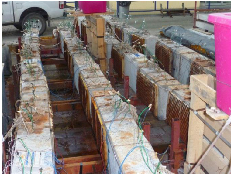
Figura 24 Humectación localizada de las vigas
