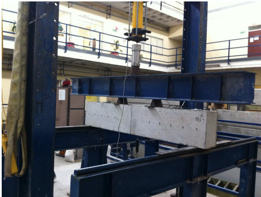
Figura 33: Ensayo de viga de concreto a flexión
