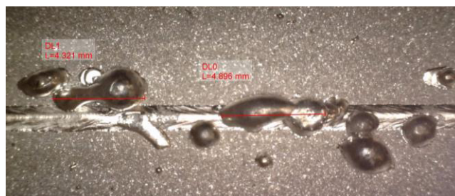
Figura 4.15 – Chisporroteo en la raíz de la condición 12 del acero 22MnB5.
