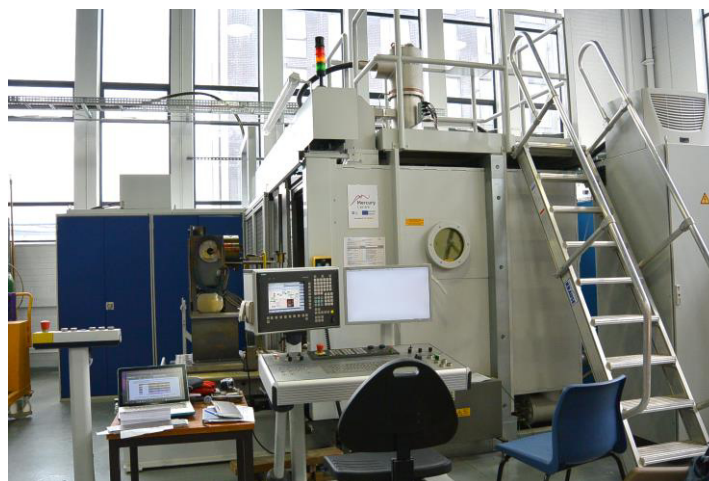
Figura 3.4 – Cámara por haz de electrones ProBeam K40, ubicada en el Mercury Centre de la Universidad de Sheffield.
