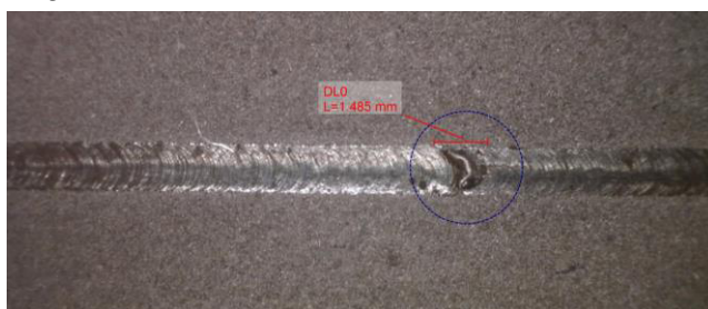
Figura 4.13 – Imperfección en el transcurso del cordón de soldadura en la condición 1 del HSLA.
