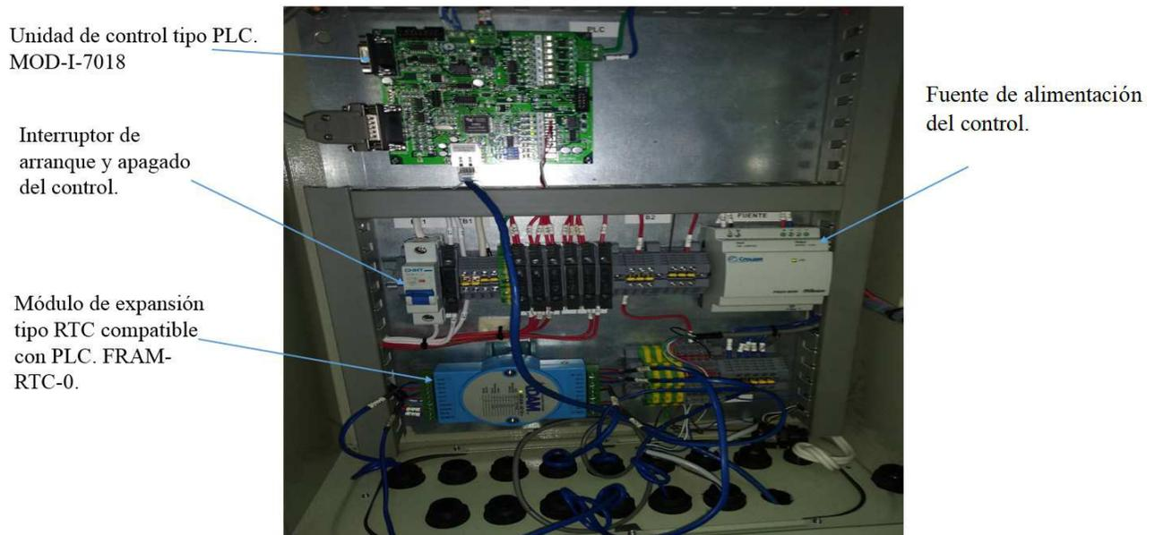
Figura 3.22: Fotografía de control de adquisición de datos
