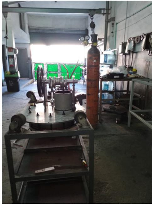
Figura 3.21: Fotografía de la instalación experimental desarrollada para medir la presión en función del volumen.
