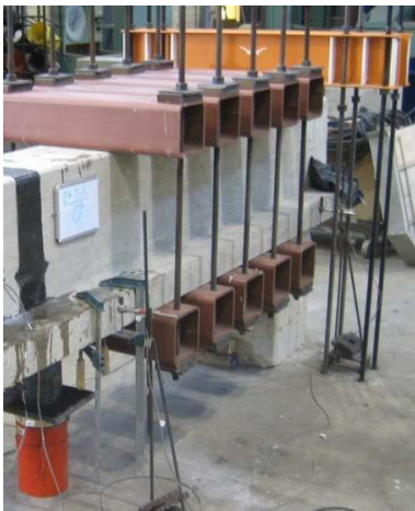
Figura 10.- Ejemplo de vigas reforzadas con tendones o pernos postensados [Kim et al. 2011].
