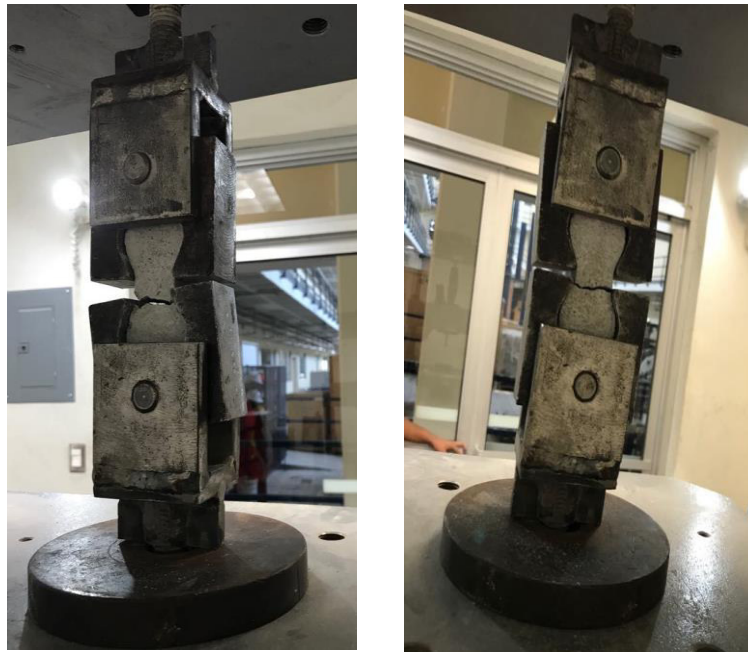
Figura 23. Patrón de agrietamiento en briquetas de mortero.
