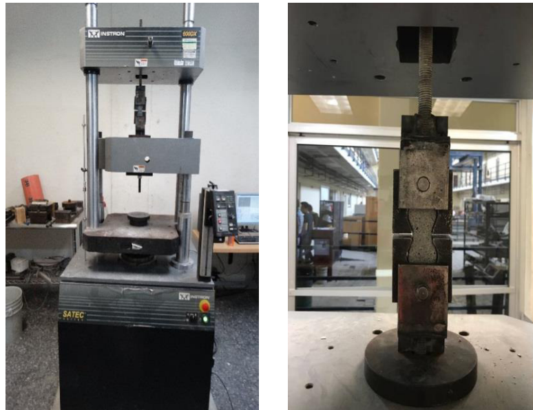
Figura 15. Ensaye de briqueta de mortero a tensión.
