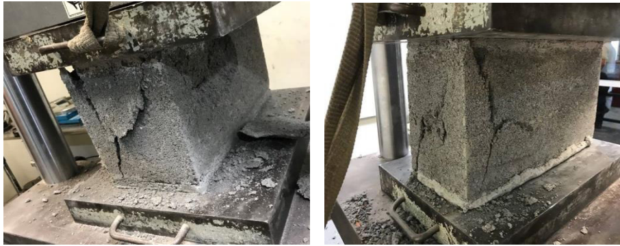
Figura 25. Patrón de agrietamiento en bloques huecos de concreto.
