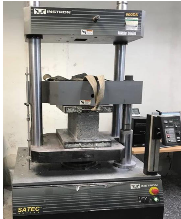
Figura 16. Ensaye de bloque a compresión.
